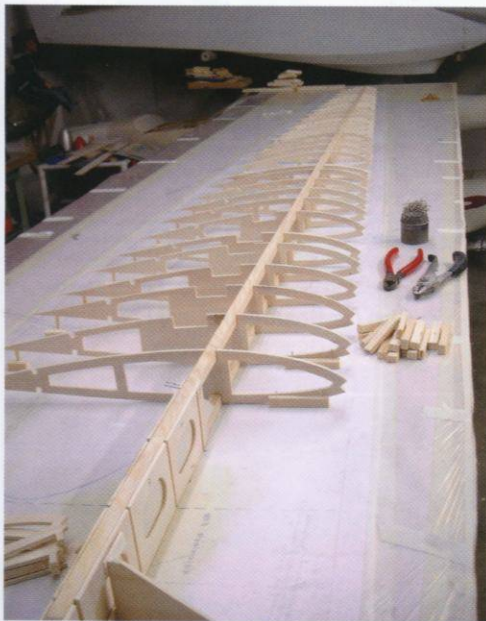
In die oberen und unteren Gurte werden die Rippen „eingefädelt“
